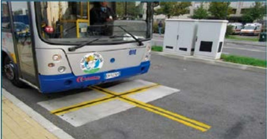
Figura 4.4—Carga inalámbrica de un bus eléctrico (Fuente: Conductix-Wampfler)<sup>209</sup>
